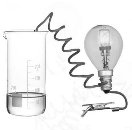
Antes de analizar cada muestra pregunte ¿Qué debe suceder en el circuito? Solicite a los estudiantes que escriban sus predicciones. Luego vaya analizando las muestras de suelo, recuerde que debe disolver el suelo en agua y limpiar los electrodos cuando cambie de muestra, formule preguntas para ayudar a los estudiantes a identificar el sen-
