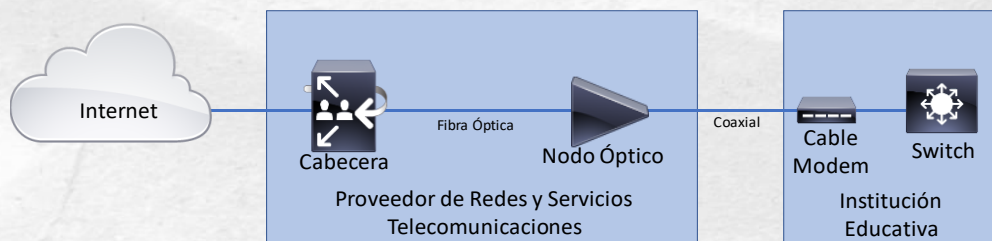
Figura 3. Tecnología de acceso HFC
