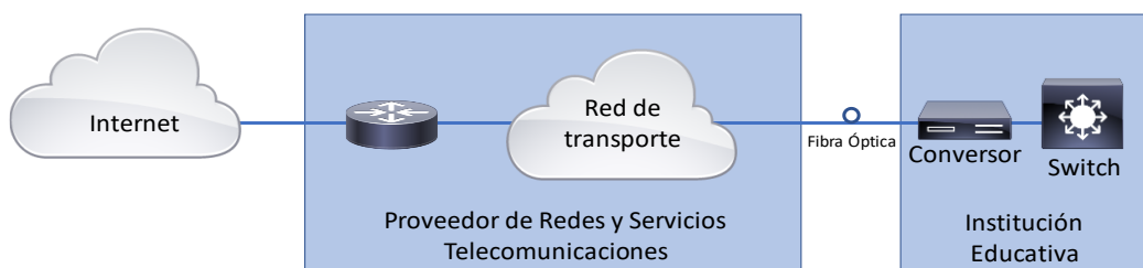
Figura 4. Tecnología de acceso por Fibra Óptica
