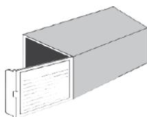
**-Diseño:** Incluye una apertura frontal con pliegue en el costado izquierdo y pestaña para su manipulación.
